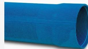
Las ranuras pueden ser de 0,50 y 0,75 mm. y de acuerdo a la granulometría del pre-filtro, el proyectista optará por la más adecuada, Los filtros poseen estrías longitudinales en el lado externo. A la altura de las roscas, no debe ser considerado el espesor de las paredes del filtro.
